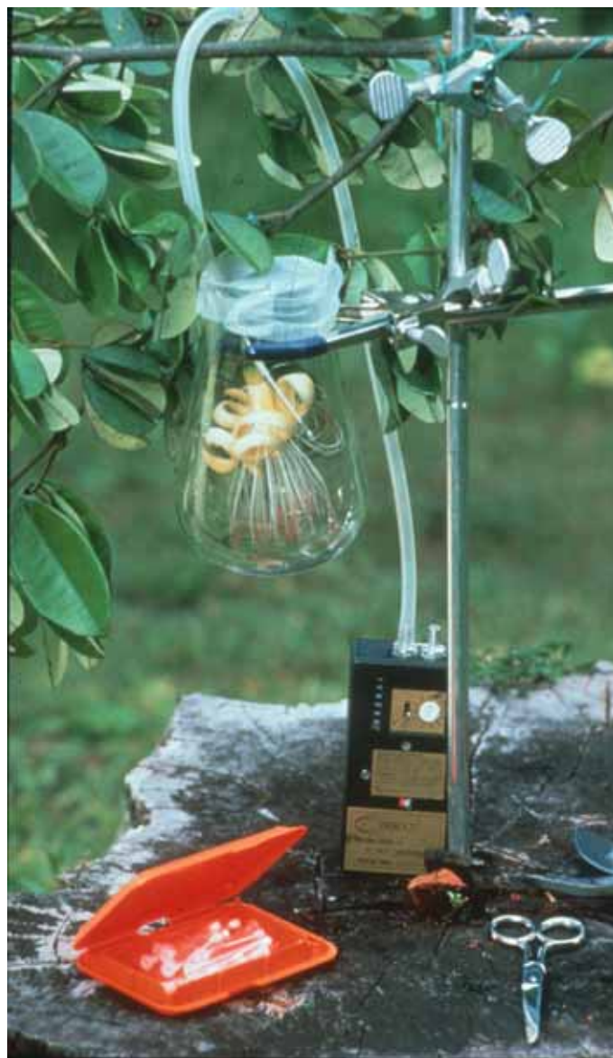
Так выглядит устройство для сбора аромата цветка в полевых условиях. Оно совершенно безопасно для растения. Технология разработана в компании «Givaudan»
