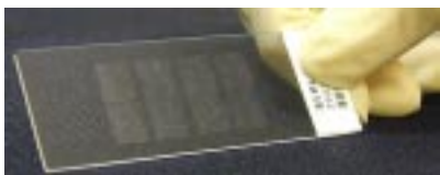
3 Фотография биочипа. На стеклянной подложке видны прямоугольные зоны, состоящие из тысяч микроскопических точек. Каждая точка — это место, где на подложке расположены фрагменты ДНК, соответствующие определенному гену
