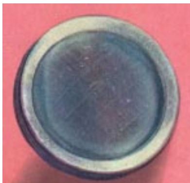
Такой диск из нержавеющей стали с нанесенным на него ничтожным количеством полония служит удобным источником \alpha -частиц для научных исследований
