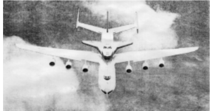
Рис. 3. Сверхтяжелый транспортный самолет «Мрия», транспортирующий «Буран»
