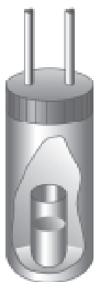
Барокамера-капсула, предназначенная для криоконсервации небольших объектов
