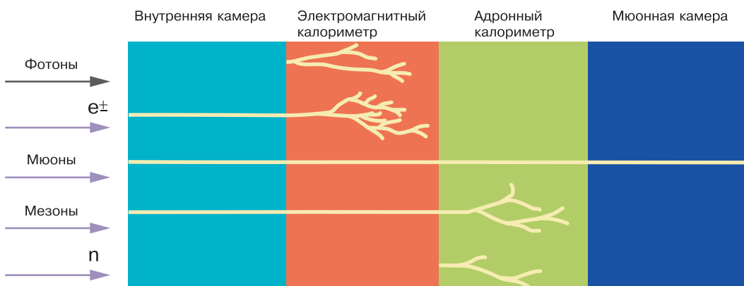
Поперечное сечение детектора в том месте, где столкнулись протоны. Частица каждого типа, затормозившись в своем слое породила вспышку, которую фиксируют датчики
