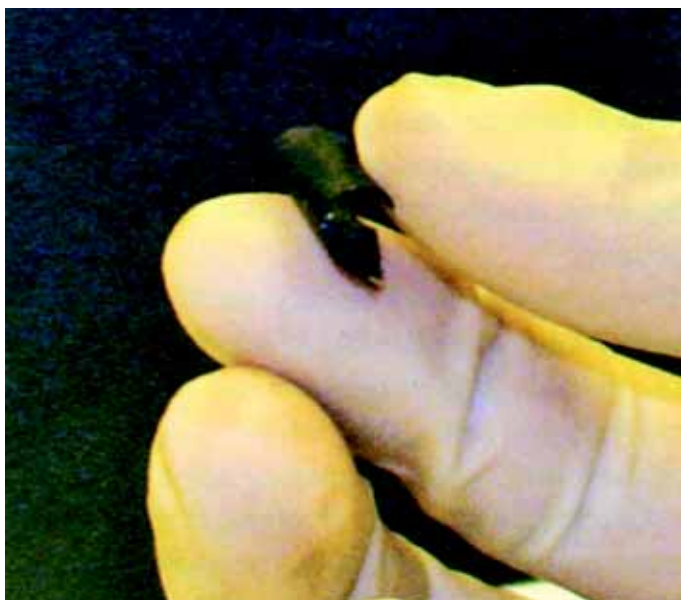
2 Гибкие батарейки с нанесенной на бумагу ионной жидкостью
